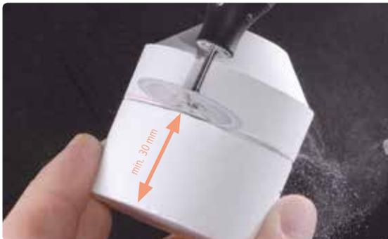
Muffel im Abstand von mind. 30 mm von der Bodenfläche mit einer Trennscheibe separieren...
