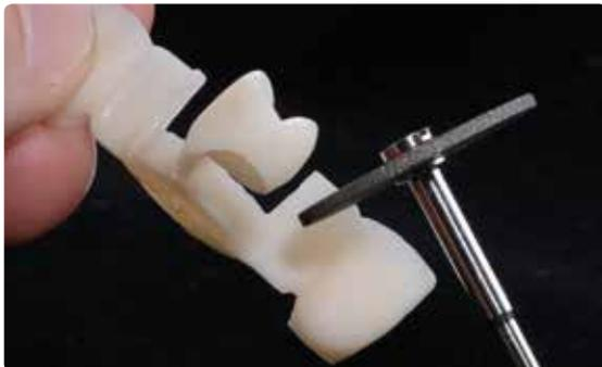
Abtrennen der Presskanäle mit einer Trennscheibe bei polychromatischen Restaurationen.
