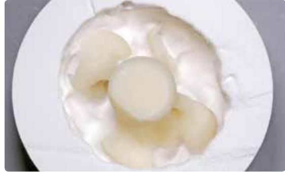
Grobausbettung erfolgt mit Glanzstrahlmittel bei 4 bar Druck, bis die Objekte sichtbar sind.
