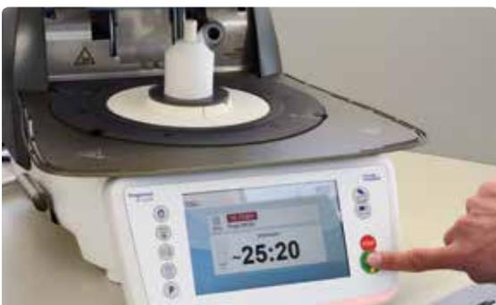
Die bestückte, **heisse** Muffel mit der Muffelzange im Zentrum des **vorgeheizten** Pressofens platzieren. Durch Drücken der START-Taste das IPS e.max Press Multi-Programm starten.
