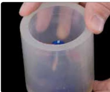
IPS Silikon Ring 200 g vorsichtig auf die IPS Multi Muffelbasis 200 g aufsetzen. Darauf achten, dass der Ring ganz auf der Muffelbasis aufsitzt.
