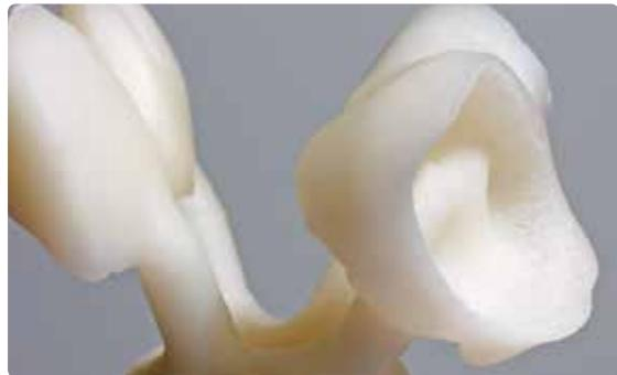
Entstandene Reaktionsschicht an den Pressobjekten mit Invex Liquid im Ultraschallbad entfernen.
