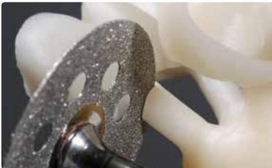
Abtrennen der Presskanäle mit einer dünnen Diamanttrennscheibe unter permanenter Befeuchtung der Schleifstelle.
