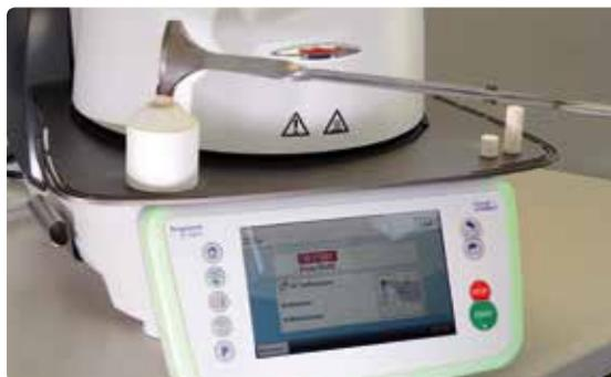
**Kalten** IPS e.max Press Multi-Rohling mit der abgerundeten unbedruckten Seite voran in die **heisse** Muffel geben. Die bedruckte Seite zeigt zur Kontrolle der Rohlingsfarbe nach oben.
