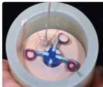
Die Einbettmasse langsam in die Muffel einfüllen, so dass diese kontinuierlich aufsteigen kann.
