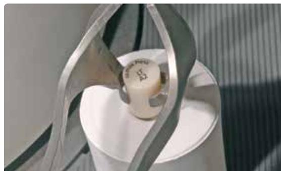
**Kalten** IPS e.max Press Rohling mit der Rohlingsfarbe nach oben in die **heisse** Muffel geben.
