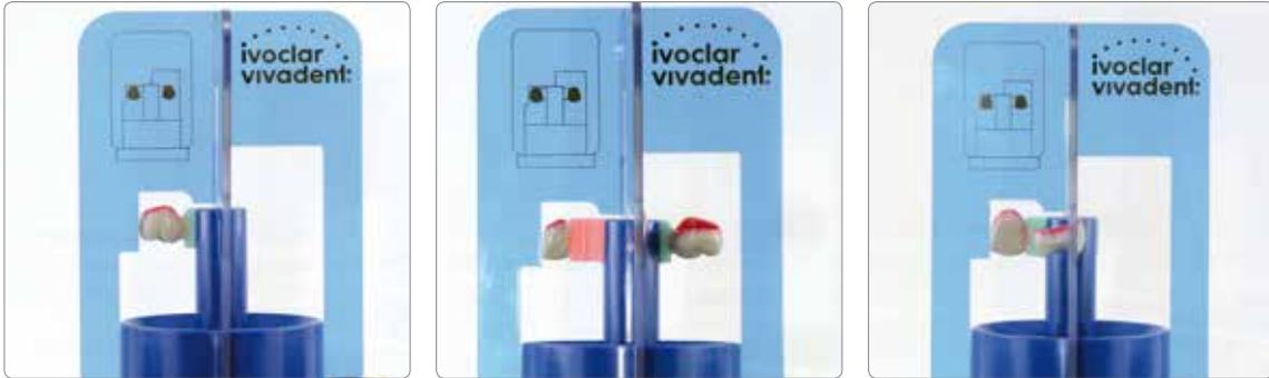
Die Modellationen mit dem IPS Multi Wax Pattern an der IPS Multi Muffelbasis 200 g anwachsen. Korrekte Positionierung mit dem IPS Sprue Guide 200 g kontrollieren.
