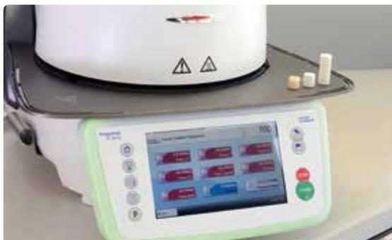
**Kalten** IPS Multi One-Way-Plunger, **kalten** IPS Alox-Kolben und **kalten** IPS e.max Press Multi-Rohling in der benötigten Farbe bereitstellen, Pressprogramm für IPS e.max Press Multi wählen.
