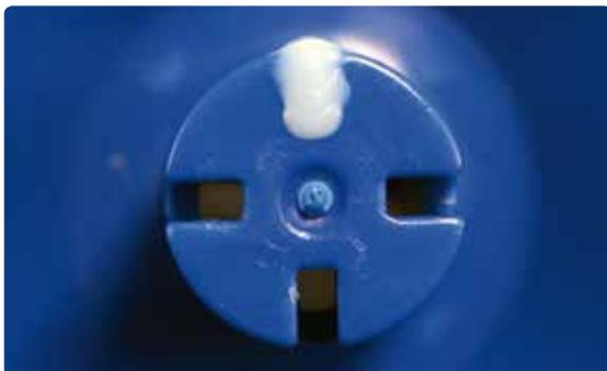
Nicht benötigte Schlitzte an der Muffelbasis mit Überschuss mit Wachs und verschliessen.
