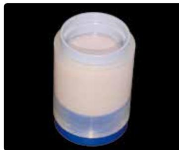
Muffel bis zur Markierung auffüllen und IPS Muffellehre in einer Kippbewegung aufstecken. Muffellehre bis zum Anschlag auf den IPS Silikon Ring aufdrücken. Der Einbettmasse-Überschuss entweicht durch die Öffnung. Eingebettete Muffel erschütterungsfrei abbinden lassen.
